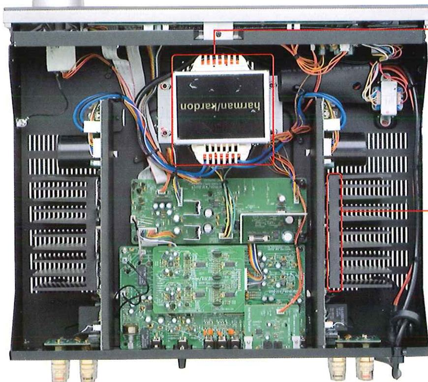
■ **ALIMENTAZIONE** - Molto accurata anche questa sezione, che vede un grande trasformatore di tipo tradizionale, l'unico elemento in comune tra i due canali. Dopo la separazione si notano due condensatori Nichicon da ben 12,000 uF ciascuno, per un totale complessivo di 48,000 uF. Con tale riserva di potenza non ci si stupisce di ottenere eccellenti dati di potenza erogata su qualunque carico.
