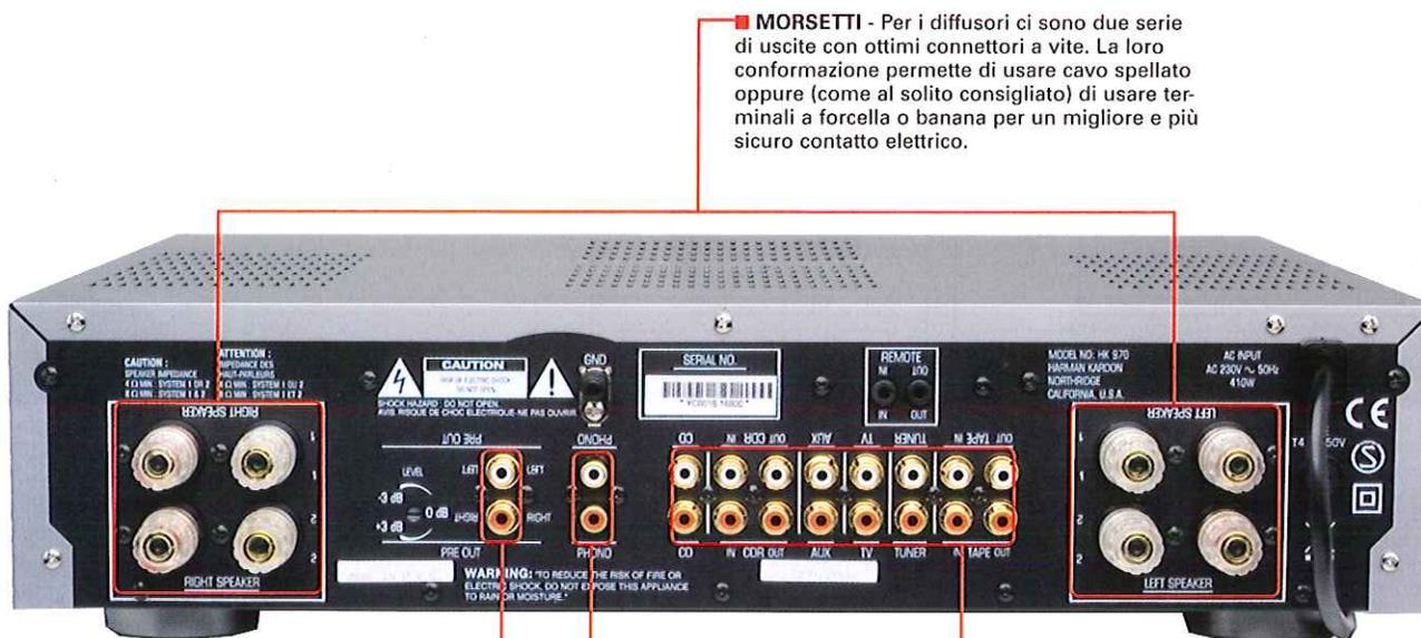
■ **MORSETTI** - Per i diffusori ci sono due serie di uscite con ottimi connettori a vite. La loro conformazione permette di usare cavo spellato oppure (come al solito consigliato) di usare terminali a forcilla o banana per un migliore e più sicuro contatto elettrico.
